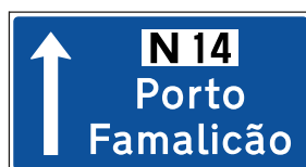
I2e - Pré-aviso gráfico (Intersecção desnivelada)
