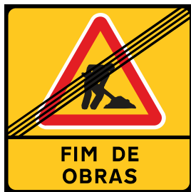
TV1 (ST14) Fim de obras Dim. 130 x 130 cm
